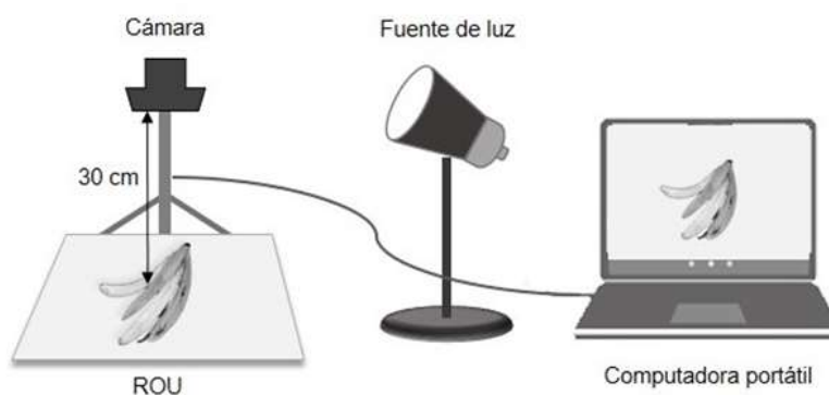
Figura 8. Sistema de captura de imágenes de ROU (elaboración propia).
