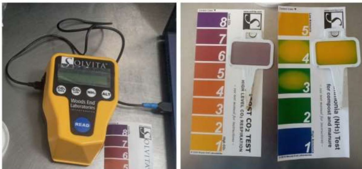
Figura 16. Medidor de CO 2 y NH 3 , geles reactivos y escala de color para la prueba Solvita®.
