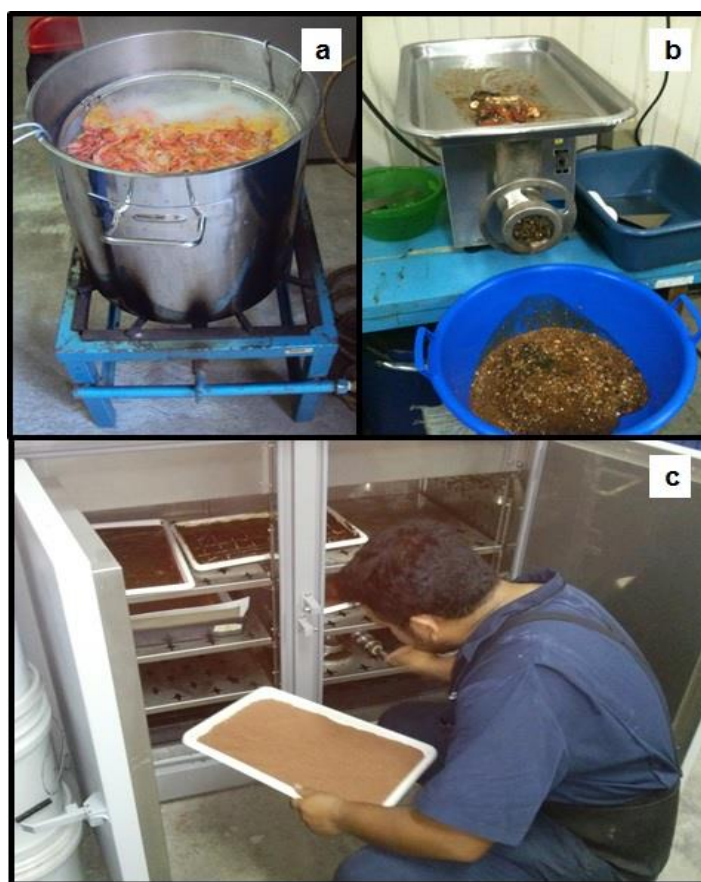
Figura 13. Procesamiento de materias primas: Los productos cocidos (a), o molidos sin cocción (b), se colocaron en charolas para ser secados en estufa de aire (c).
