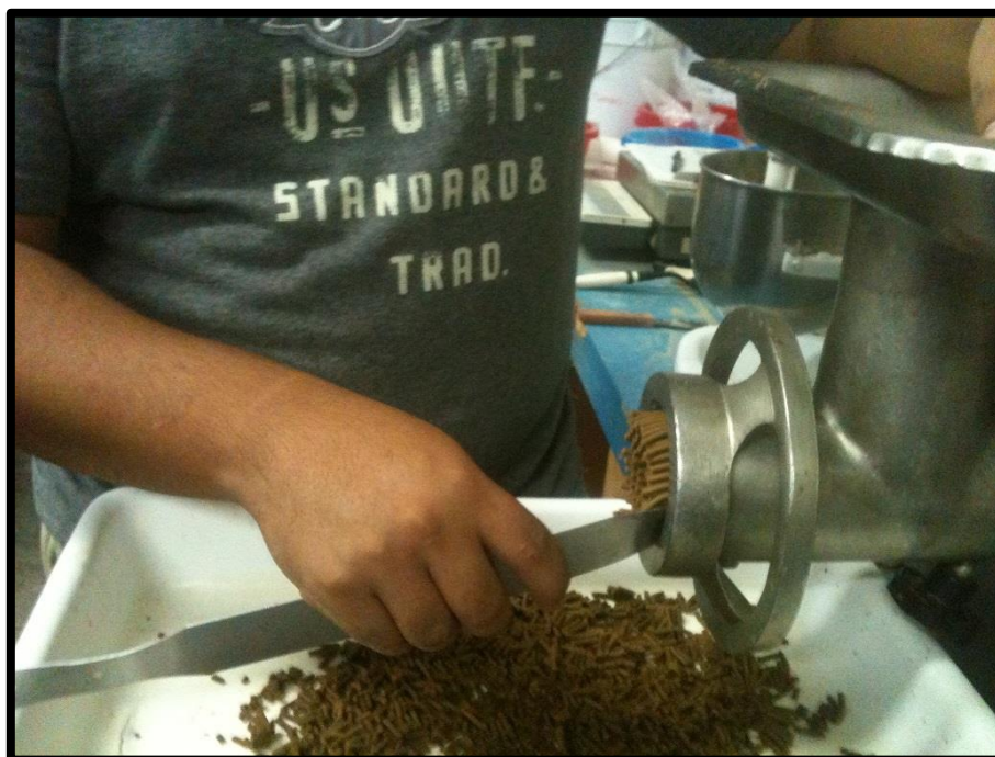
Figura 14. Extruido y cortado de pellets para el bioensayo de crecimiento
