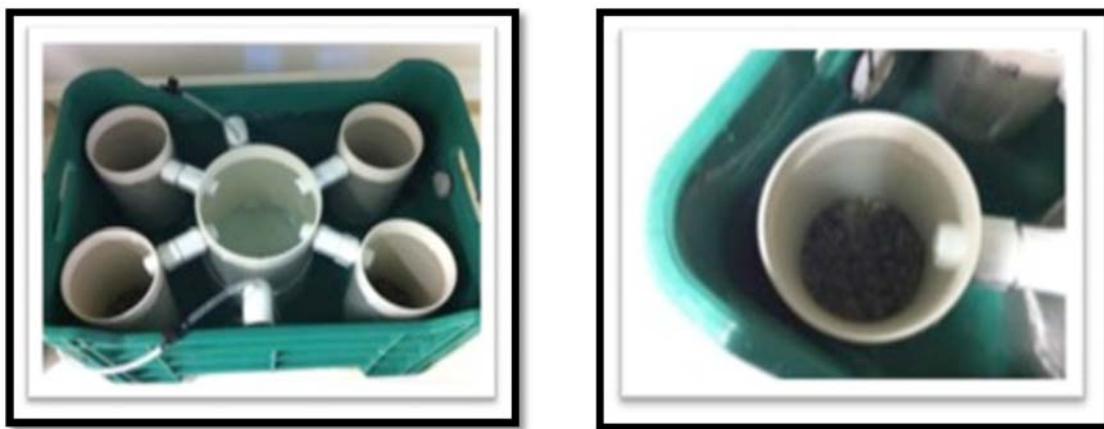
Figura 10. – Unidades de Pre-engorda de semillas de moluscos con tamaño representativo, constituidas por una caja contenedora plástica y cilindros de surgencia con falso fondo de malla plástica construidos con tubería PVC de 4 y 6 " que operan manteniendo un flujo ascendente y recirculante por medio de aerosifones (Diseño: Mazón-Suástegui 2014, CIBNOR, S.C.).
