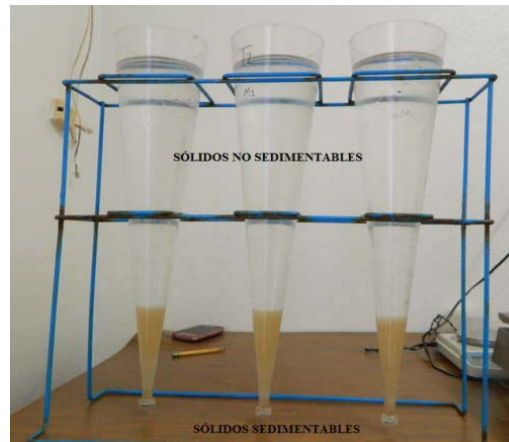
Figura 8.- Toma de muestra de la parte sedimentable y no sedimentable.
