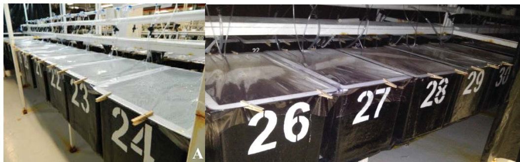
Figura 6.- Sistema de biomineralizadores quimioautótrofos A) Serie de mineralizadores. B) Sistema protegido con cubierta plástica para evitar contaminación cruzada.
