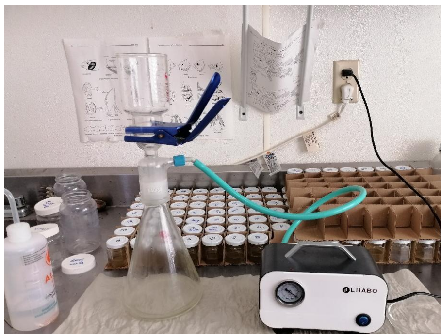
Figura 9. Equipo de filtración, con bomba de vacío.
