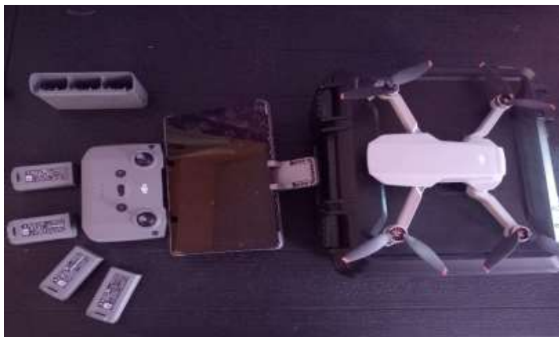
Figura 2. Vehículo aéreo no tripulado DJI SE 2, con cuatro baterías adicionales, controlado a distancia desde tierra con DJI Smart Controller con extensor para pantalla.
