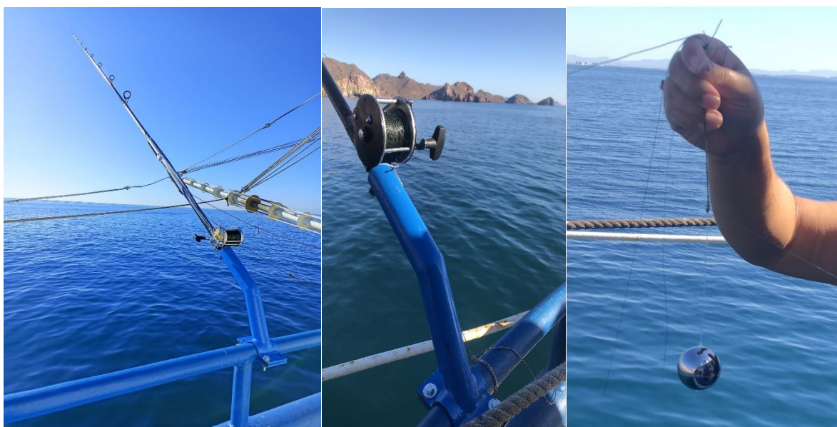
Figura 6. Caña de pesca colocada en la banda de babor; soporte de cañas y rollo de monofilamento; esfera de carburo de tungsteno utilizada para la calibración
