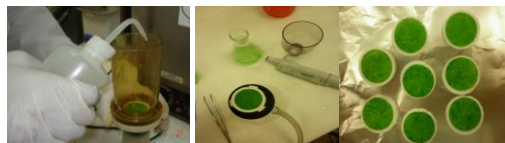
Figura 1: Filtración y lavado de muestras de microalgas. Imágenes tomadas en el CICESE.
