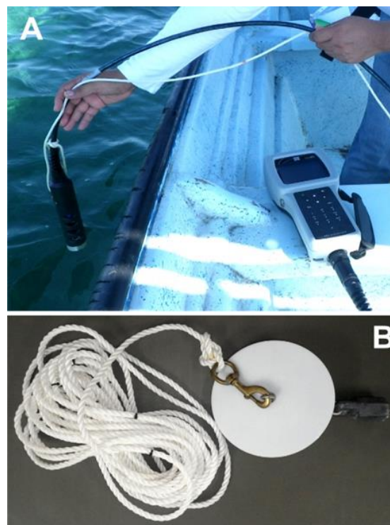
Figura 1. Equipos hidrológicos básicos: (A) Sonda multiparamétrica, (B) Disco de Secchi.
