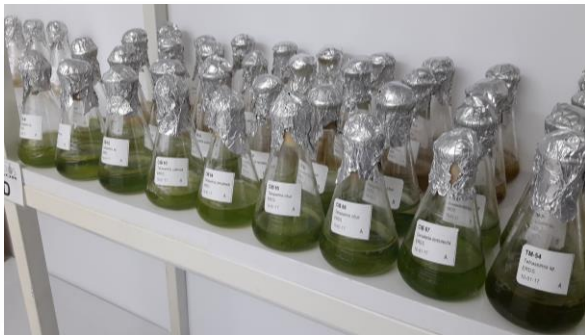
Figura 5. Mantenimiento en matraces Erlenmeyer de 125 mL con tapones de fomi recubiertos con papel aluminio. Cepario del CIBNOR.
