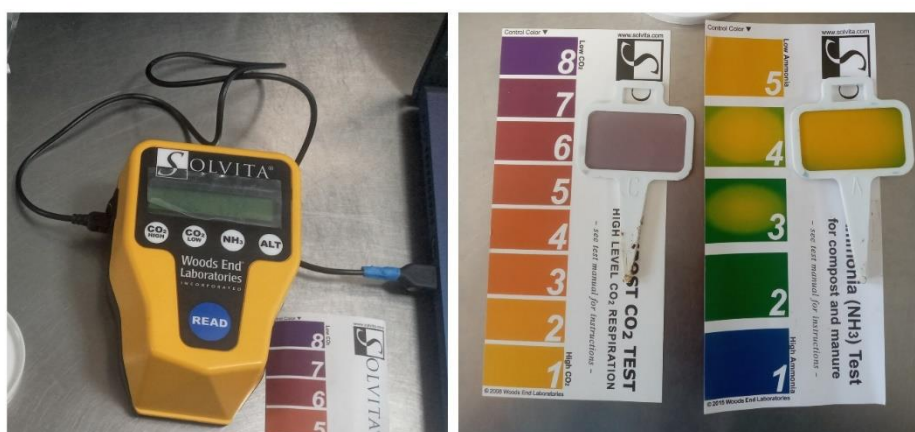
Figura 16. Medidor de \text{CO}_2 y \text{NH}_3 , geles reactivos y escala de color para la prueba Solvita®.
