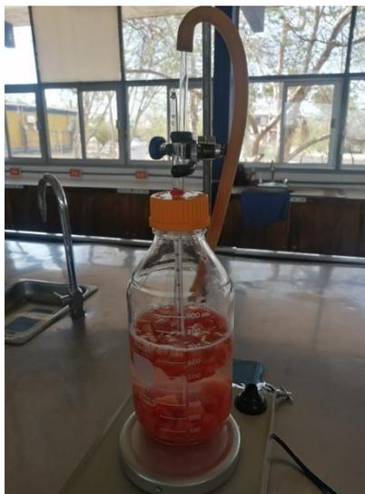
**Figura 2.** Modelo de evaluación para biorefinería. El modelo incluye inóculo, medición de temperatura, agitación y efluente controlado.
