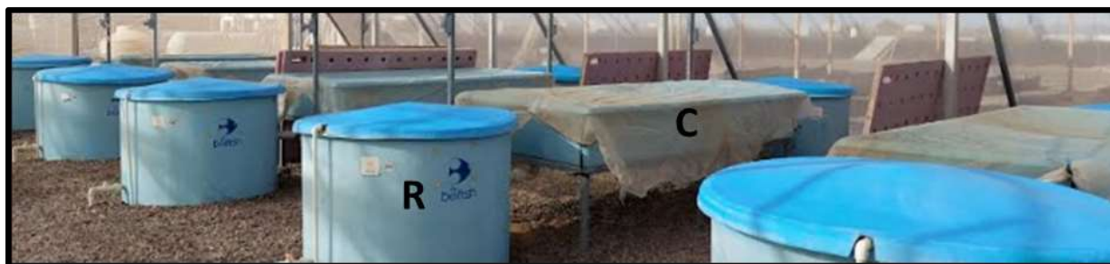
Figura 5. Unidades experimentales hidropónicas de raíz flotante (cama y reservorio). R= reservorio de la solución nutritiva, C= cama de cultivo para las plantas.
