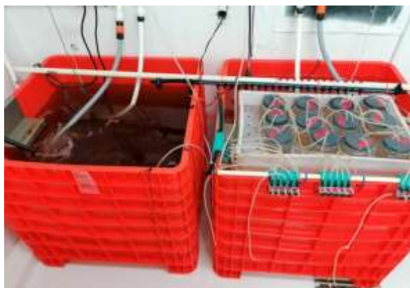
Figura 6. Sistema de incubación de juveniles de N. subnodosus con cámaras de flujo continuo. Izquierda, tanque de alimentación con Isochrysis galbana suministrado mediante bombeo; derecha, cámaras individuales con organismos sometidos a bioensayos térmicos.
