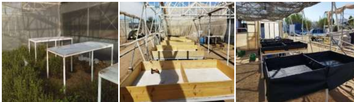
Figura 11. izquierda: mesas utilizadas para el experimento; centro: mesas con las tablas fijadas en el perímetro; derecha: revestimiento de las mesas con geomembrana.
