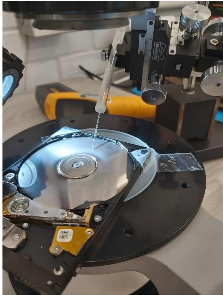
Figura 12. Montaje del sistema de biselado. Compuesto por un disco magnético de un disco duro energizado a partir de una fuente de poder externa, un estereoscopio y un micromanipulador.
