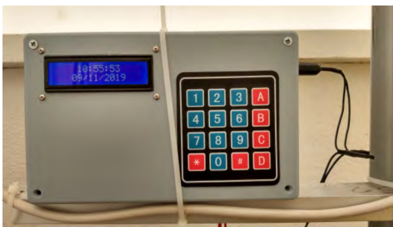
Figura 20. Módulo de control de irrigación. Se logra apreciar el LCD informativo en color azul y el teclado de configuración en una matriz negra con colores secundarios.
