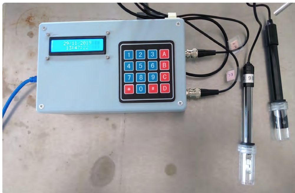
Figura 18. Módulo de medición de variables químicas. Las sondas, son los sensores de pH y C.E. Se logra apreciar el LCD informativo en color azul y el teclado.
