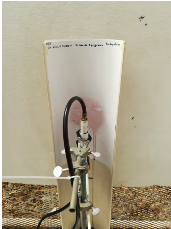
Figura 2. Perfil de PVC y montaje de aspersor para la realización de imágenes.
