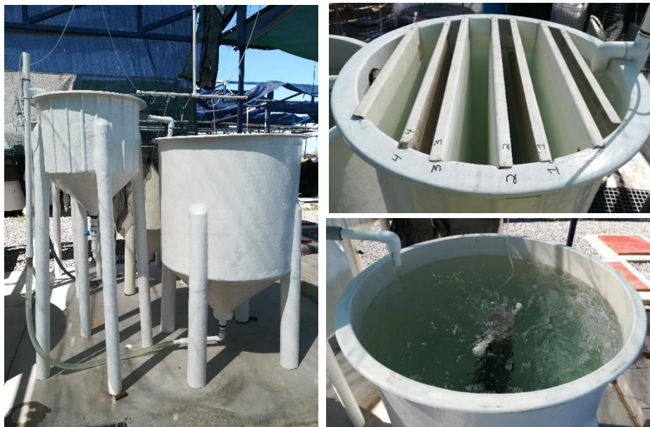
Figura 1 del Anexo G. Sistema de Recirculación (RAS).
