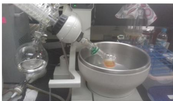
5. Evaporación de solvente de la muestra
