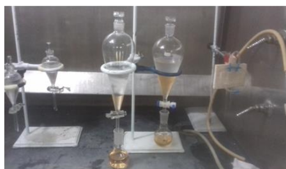
4. Separación de extracto lipídico en embudo de separación
