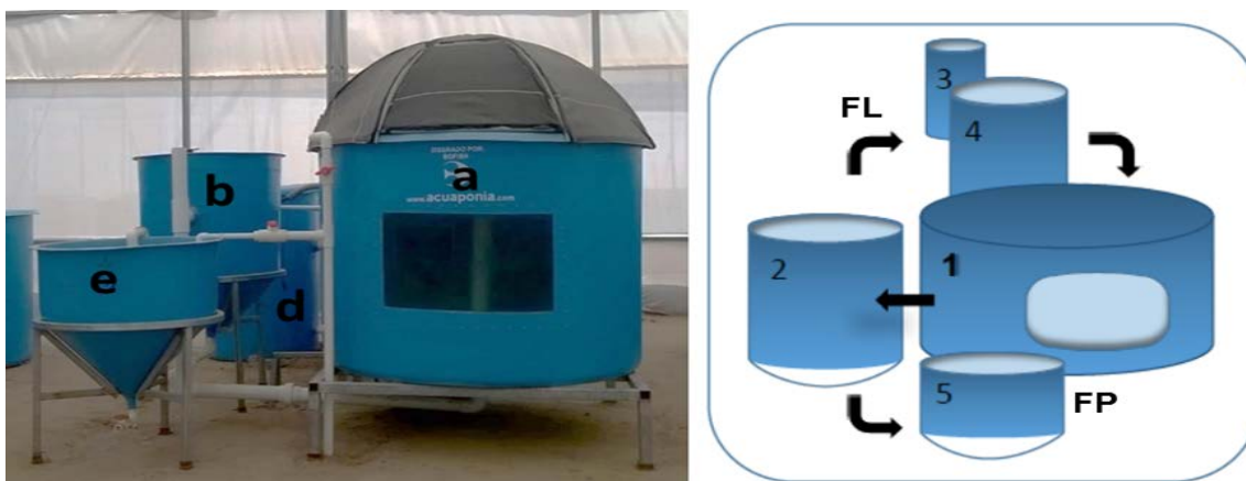
Figura 13. Sistema individual conformado por: a) 1 tanque de 1 m 3 , b) un sedimentador de 156 L, c) un fraccionador de espuma 5 L, d) un bionitrificador 339 L, e) un tanque cónico de mineralización 89 L y, f) una bomba 60 W. Las flechas negras indican el flujo del agua dentro del sistema: 1-4 indican el flujo de la FL y 1, 2, 5 indican el flujo de la FP. FL= fracción líquida, FP=fracción particulada.
