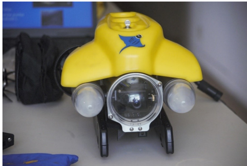
Figura 2. ROV (Remote Operated Vehicle) modelo VideoRay Pro 4, utilizado en el presente estudio.
