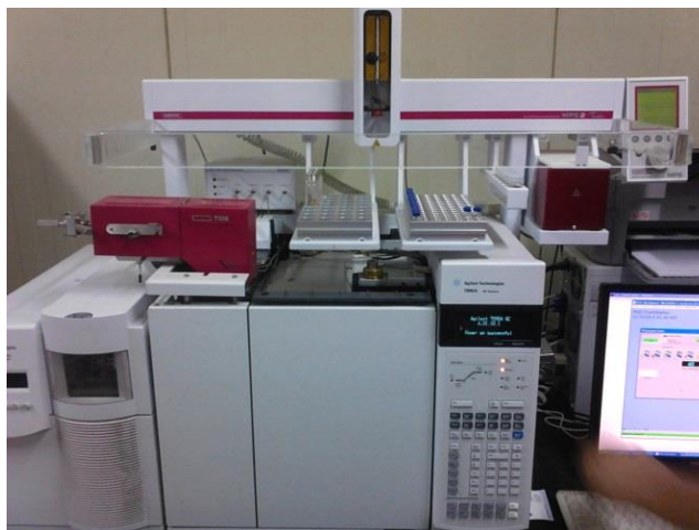
Figura 9. Cromatógrafo de gases-Masas Agilent Technologies 7890 a utilizado para el análisis de compuestos volátiles bacterianos.
