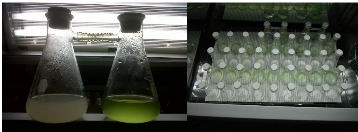
Figura 6. Sistema tratamiento de matraces kitasato duales con conexión en incubación.
