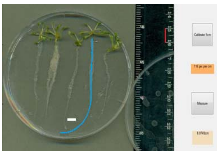
Figura 7. Interface gráfica de usuario para medir la longitud de la raíz. En rojo la recta de calibración, en azul los segmentos de recta que permiten obtener la longitud de la raíz, en este caso 8.07 cm.
