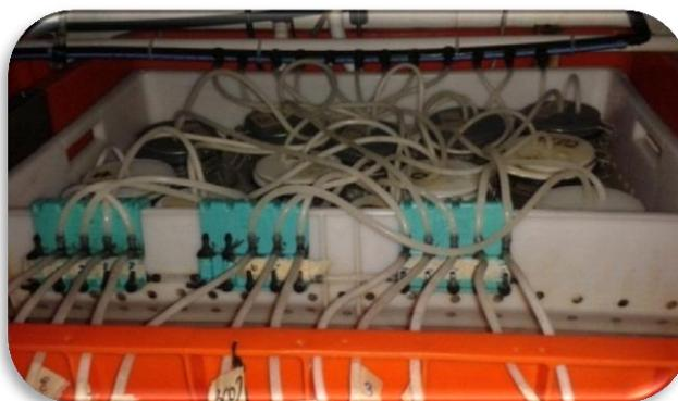
**Figura 4.** Sistema de cámaras de incubación herméticas, alimentadas mediante un sistema de flujo continuo y utilizadas para determinar la tasa respiratoria.
