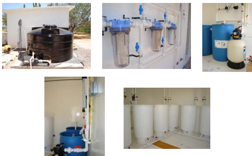
Figura 32. Sistema experimental con circulación de agua cerrada, en el bioterio del CIBNOR.
