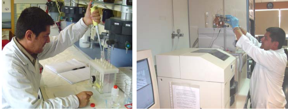
Figura 9. Detección de neurotoxinas mediante el método de McNabb y colaboradores (2007). Las muestras se limpian (“cleanup”) con cartuchos de extracción en fase sólida (SPE) (a) para posteriormente detectar las toxinas LC-MS (b) . Fotos: J. Pérez-Linares.
