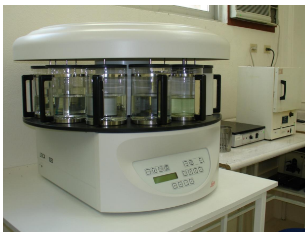
Figura 1. Histoquinet Leica© modelo TP1020 para realizar deshidratación e infiltración de parafina en muestras de tejido.
