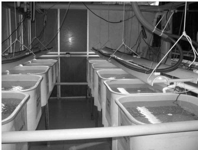
Figura 2. Fotografía del sistema de crianza larvaria de circulación cerrada (SCC-18) instalado en la UPIMA del CICIMAR-IPN
