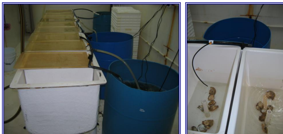
Fig. 40 Sistemas utilizados en el experimento. En cada uno de los sistemas (tanques azules) se colocó diariamente el alimento de cada una de las dietas, el cual se suministró por goteo a cada una de las 3 réplicas (30 ostiones \times dieta).
