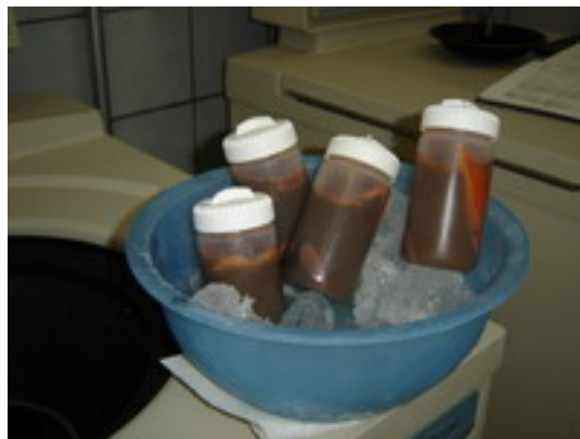
Figura 5. Extracto centrifugado de langostilla (14,000rpm; 15 minutos a 4^{\circ}\text{C} )
