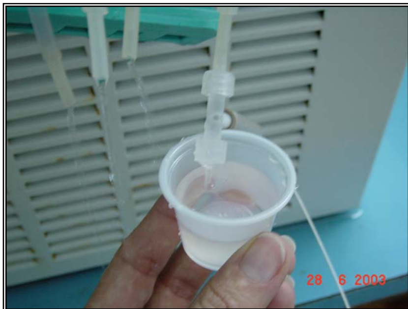
FIGURA 9. Toma de muestra del agua (20 mL) de la cámara para analizar la concentración de partículas.
