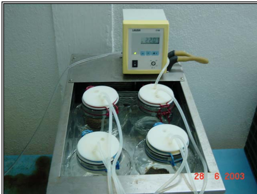
FIGURA 7. Sistema de flujo continuo para el monitoreo de tasas fisiológicas utilizado con la almeja mano de león ( Nodipecten subnodosus )
