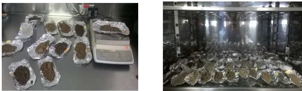
Figura 7. Lectura de pesos de muestras de tierra para porcentajes de humedad.
