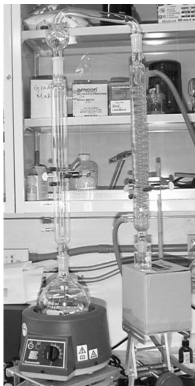
Figura 5 Aparato de destilación empleado para cuantificar BVT-N
