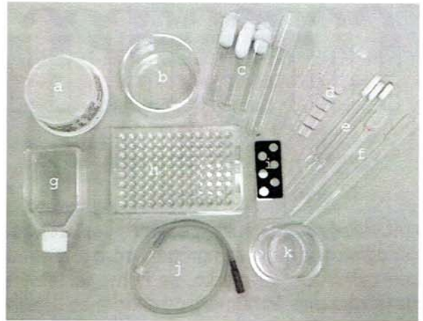
Figura 2. Material empleado para el aislamiento de células fitoplanctónicas. a) tamiz, b) recipiente de vidrio, c) tubos de vidrio con tapas, d) pipetas capilares, e) pipetas Pasteur, f) pipetas de transferencia, g) recipiente para cultivo de tejidos, h) placa multipozo, i) portaobjeto, j) manguera que se inserta a pipeta capilar o Pasteur para la captura de células, k) caja de Petri.
